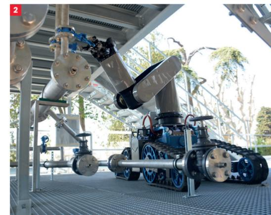
1 Tâche d'inspection et maintenance (manœuvre de vanne) réalisée en téléopération à retour d'effort
