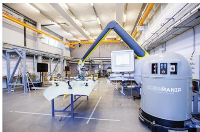
Application du Cobomanip à la manutention de structures aéronautiques Crédit : Cyrille Dupont
